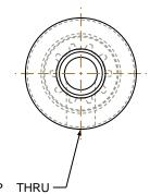
\$ 6-40 UNF- 2B TAP THRU- #33 DRILL ( 0.110 )  $\overline{\rm V}$  0.200 -( 1 ) HOLE
