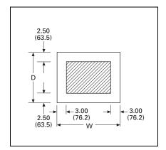
Figure 21.10-6. Typical Conduit Area
