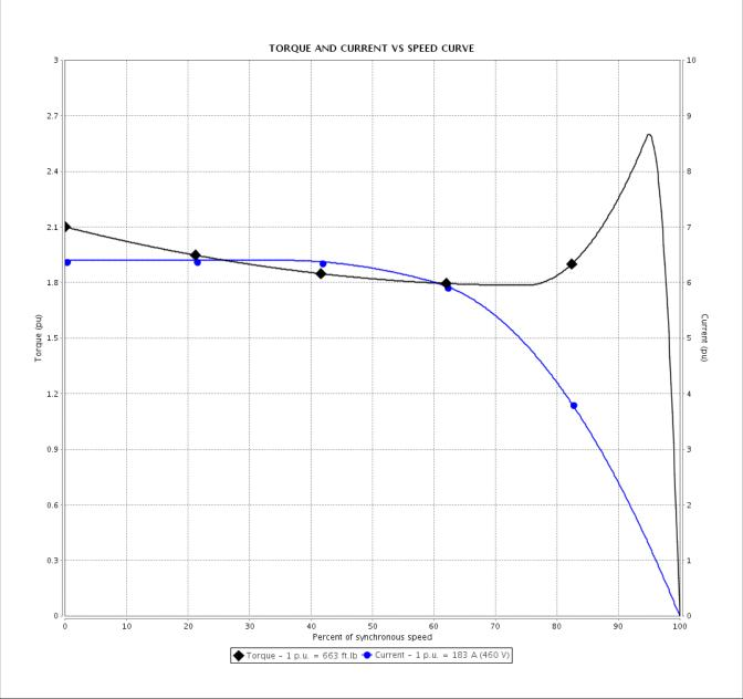
Performance : 460 V 60 Hz 6P Rated current : 183 A Moment of inertia (J) : 79.0 sq.ft.lb **LRC** : 6.4 Duty cycle : Cont.(S1) : 663 ft.lb Insulation class Rated torque : F Service factor Locked rotor torque : 210 % : 1.25 Breakdown torque : 260 % Temperature rise : 80 K Rated speed : 1188 rpm Design : B
