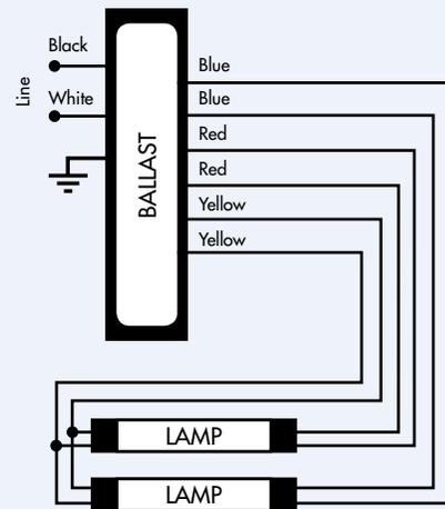
**WIRING DIAGRAM FOR 2 LAMP OPERATION ESR416**
