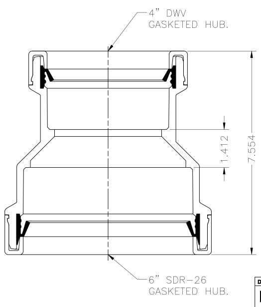
ADAPTER DWV GASKET HUB X SDR-26 GASKET HUB
