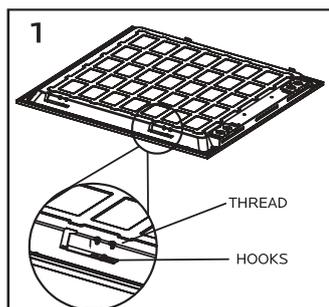
1. Couper l'alimentation, s'assurer que les crochets du câble du panneau à rétroéclairage sont installés.
