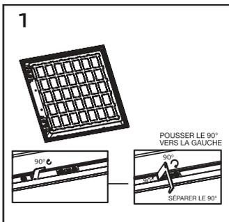
1. Retirer la tuile du plafond originale pour installer le panneau DEL à rétroéclairage.
