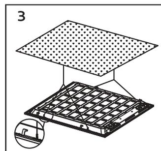
3. Accrocher le câble dans les crochets du panneau à rétroéclairage.
