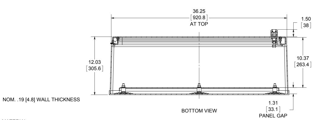
MATERIAL: BOX- GEL-COAT, FIBERGLASS, RESIN COVER- GEL-COAT, FIBERGLASS, RESIN EPDM GASKET SEAL
