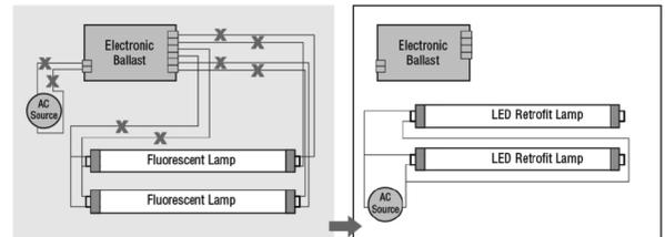
**FIG 3 - Retrofit avec 2 lampes**
