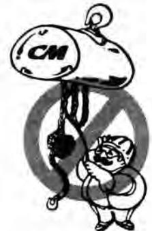
**WARNING** — DO NOT PULL AT AN ANGLE. BE SURE HOIST AND LOAD ARE IN A STRAIGHT LINE.
